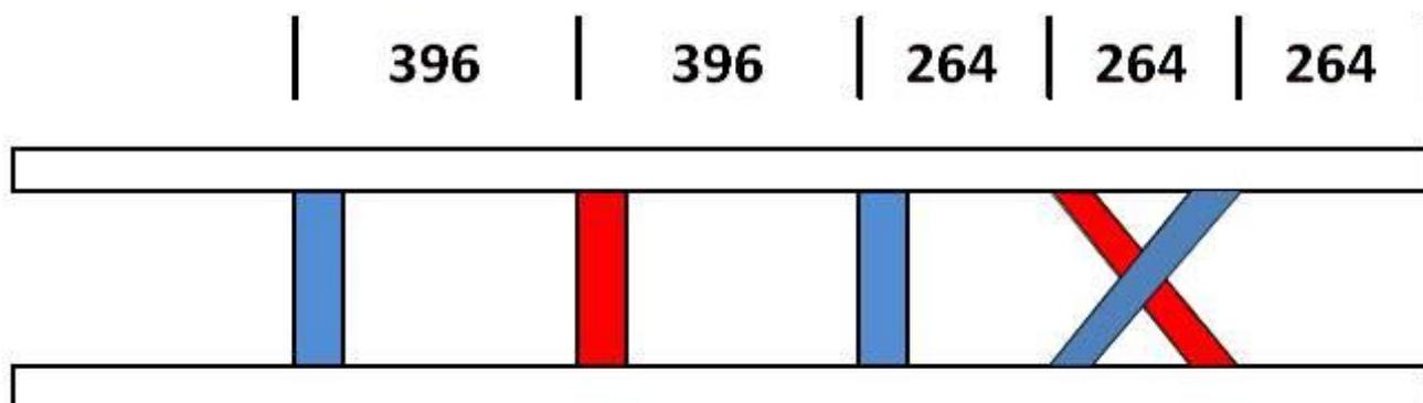
Après avoir terminé l'étape 5, il faut retourner l'échelle avec la traverse et la diagonale de monté et vous assemblez sur l'autre côté du montant la deuxième diagonale et les deux traverses (en bleu sur le schéma)
