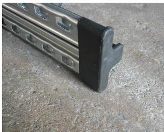
Mettre les embouts plastiques sur les montants du côté de la diagonale
