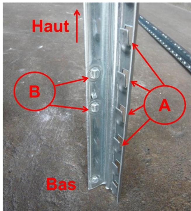
Prendre un montant vérifier le sens des **encoches (repère A)**, elles doivent être comme sur la photo). Les encoches A sont utilisées pour la fixation des lisses de niveaux, elles sont de chaque côté du montant
