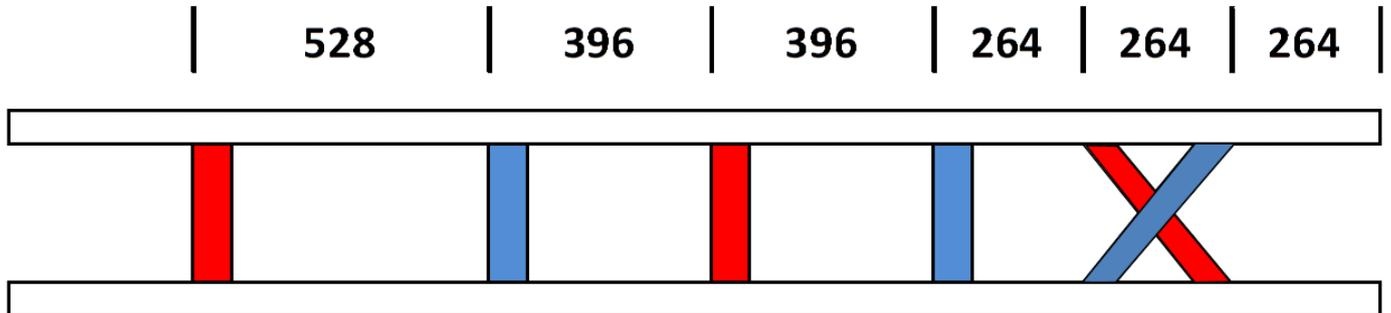
Après avoir terminé l'étape 5, il faut retourner l'échelle avec la traverse et la diagonale de monté et vous assemblez sur l'autre côté du montant la deuxième diagonale et les deux traverses (en bleu sur le schéma)
